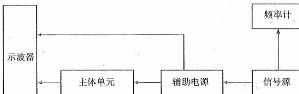
图 1: 光泵磁共振实验装置方框图
