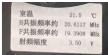
图 4 实验仪的共振频率大致范围
